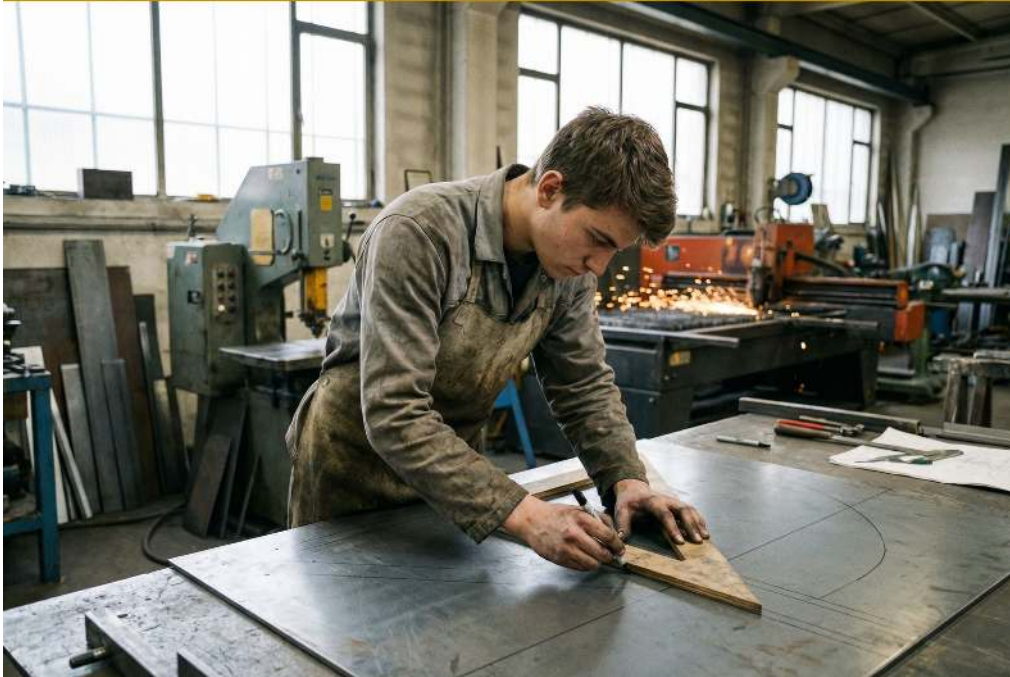
Traçage des pièces avec un gabarit pour éviter les erreurs de découpe
