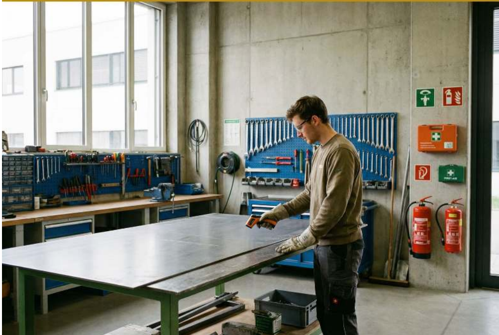
Mesurer la température de préchauffage à 120 °C avant soudage
